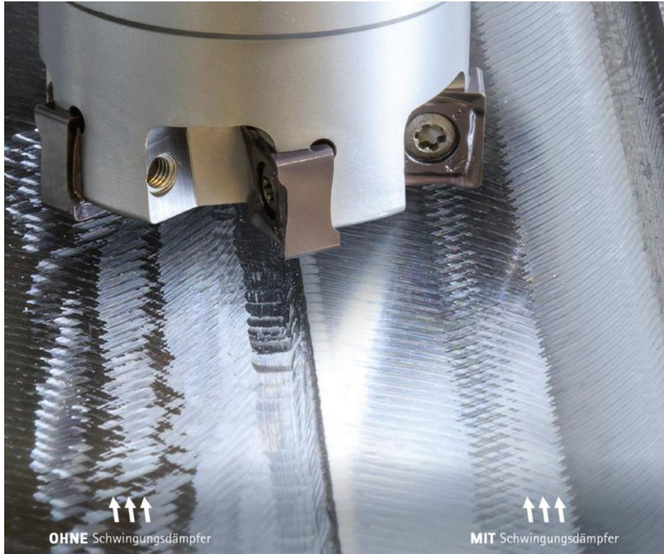
Dank der neuen Fräseraufsteckdorne mit Schwingungsdämpfung werden bessere Oberflächengüten erreicht. Bild: Mapal
