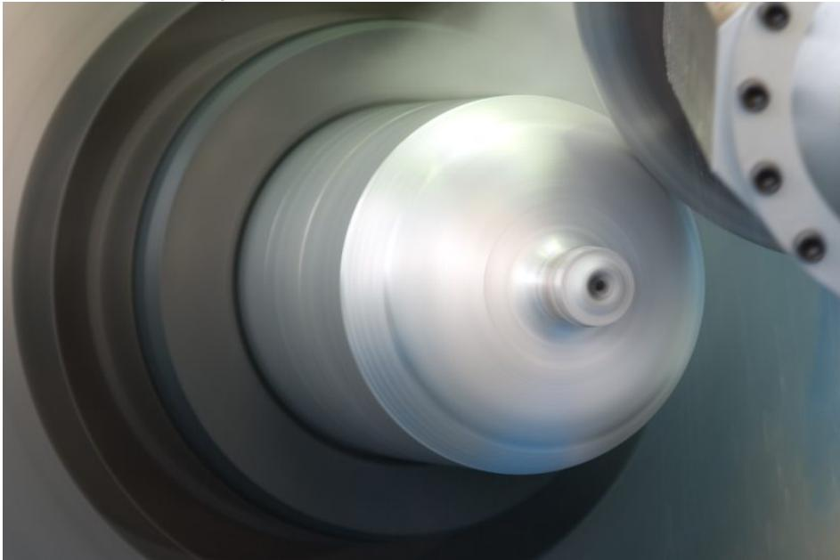
Die neue Einziehmaschine wurde gezielt für die Fertigung von Wasserstofftanks entwickelt (Bild: Leifeld).
