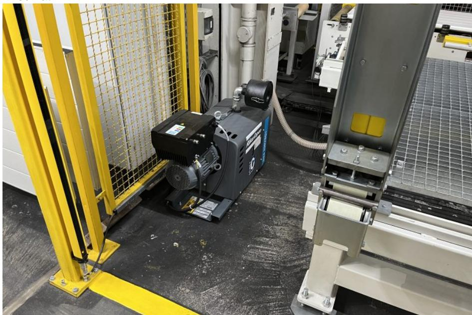
Die Vakumpumpe mit integrierter Frequenzumrichtertechnologie arbeitet mit hohem Wirkungsgrad (Bild: Oltrogge).
