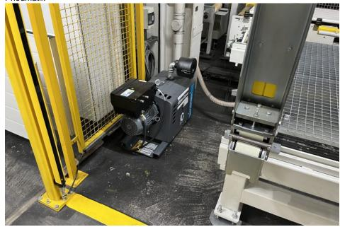
Die Vakuumpumpe mit integrierter Frequenzumrichtertechnologie arbeitet mit hohem Wirkungsgrad (Bild: Oltrogge).
