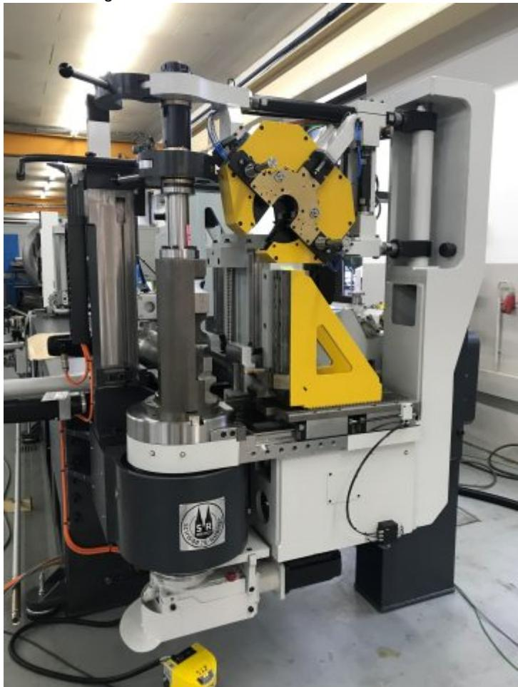
Die vollelektrische Multiradius-Rohrbiegemaschine schafft Biegen und Trennen innerhalb sehr kurzer Taktzeiten (Bild: Schwarze-Robitec).
