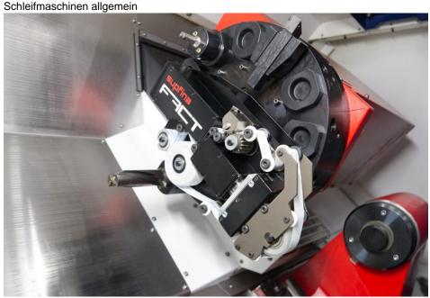
Das Superfinish-Anbaugerät erweitert die Funktionalität von Drehmaschinen (Bild: Supfina).
