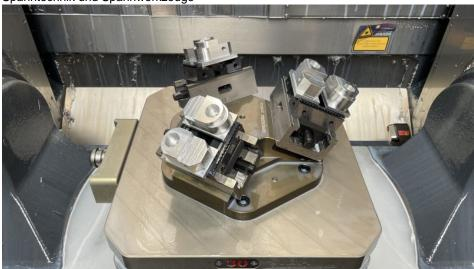
Die 3-fach-Pyramide des Nullpunktspannsystems eignet sich z. B. für die Palettenautomation (Bild: Gressel).
