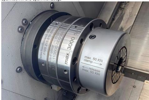
Das neue Spannhülsen-Spannfutter bietet mehr Flexibilität und ermöglicht reduzierte Rüstzeiten (Bild: Ringspann).
