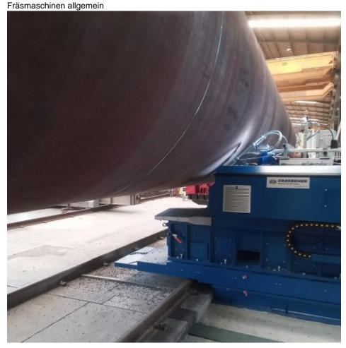
Mit der 45 kW-starken Rundnahtfräse lassen sich Windturmsektionen von 1300 bis 5500 mm Durchmesser bearbeiten (Bild: Gräbener).
