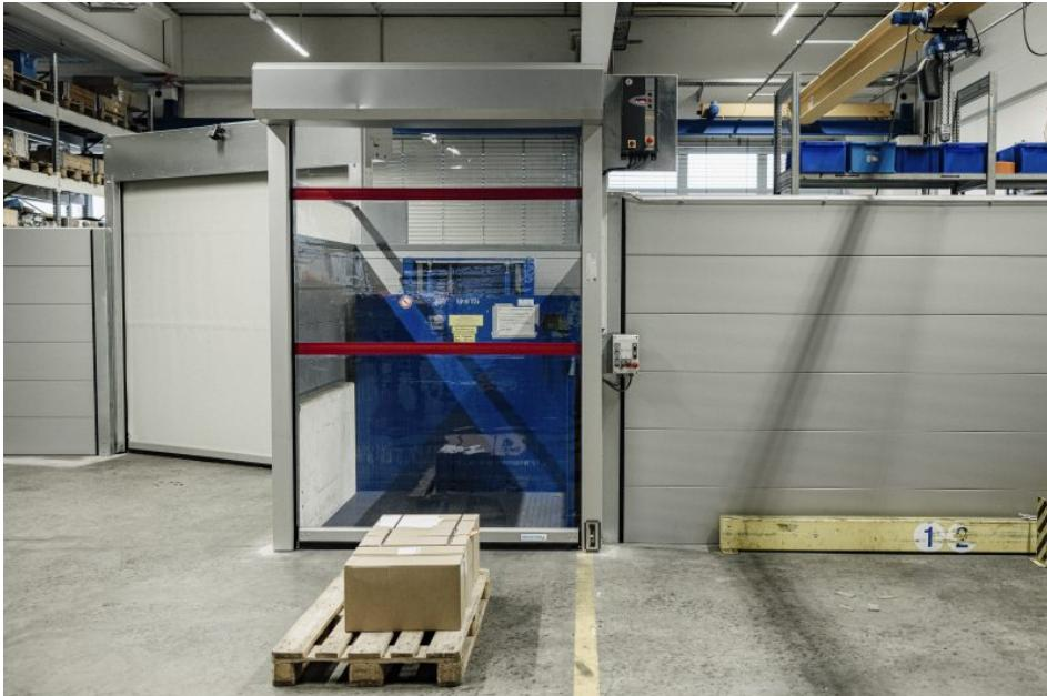
Das Maschinenschutztor erreicht Performance Level d (Bild: Seuster).
