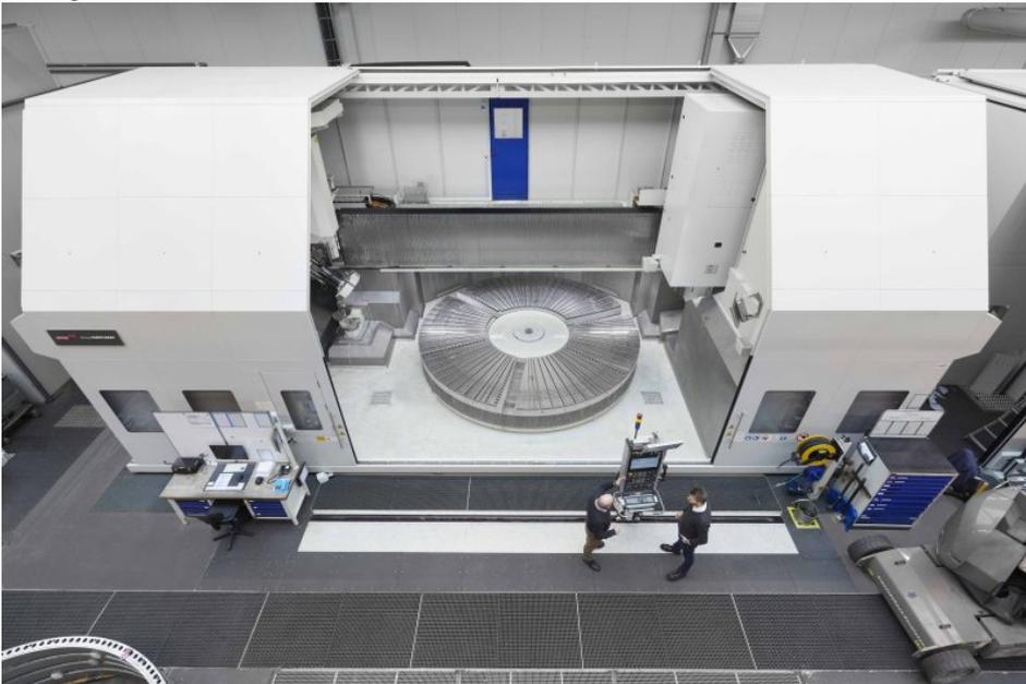
Die neue Vertikal-Dreh-Schleifmaschine passt zum aktuellen Trend zu immer größeren Windkraftanlagen und entsprechend größeren Wälzlagerringen (Bild: Starrag/Ralf Baumgarten).
