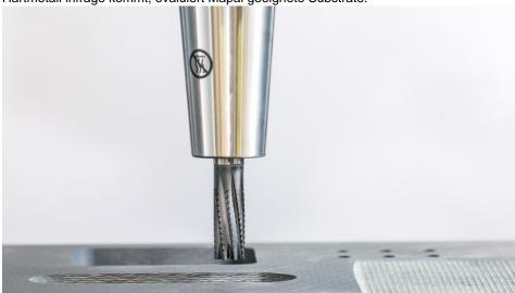
Die homogene CVD-Diamantbeschichtung sorgt für lange Standzeiten und hohe Prozesssicherheit, z. B. beim VHM-Fräser »OptiMill-Composite-Speed-Plus« für CFK-Werkstoffe (Bild: Mapal).
