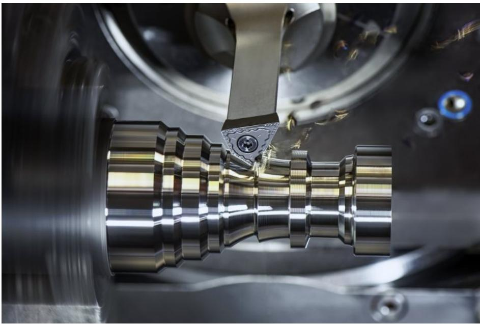
Mit »High Dynamic Turning« lassen sich mehrere Drehanwendungen mit nur einem dynamischen Werkzeug durchführen. Bild: Ceratizit
