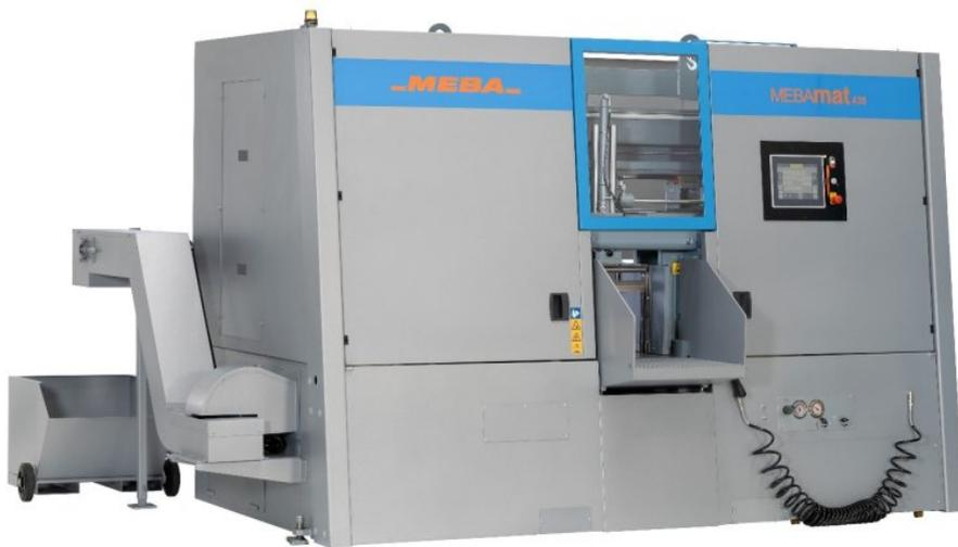
Der hartmetalltaugliche Sägeautomat mit Dünnschnitttechnologie verkürzt die Sägezeit deutlich (Bild: Meba).
