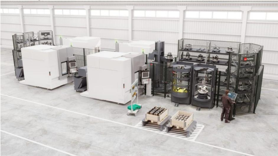
Die kompakte, modulare Automationslösung ist für 4- und 5-achsige Fräs- sowie Fräs-/Drehzentren konzipiert (Bild: Fastems).
