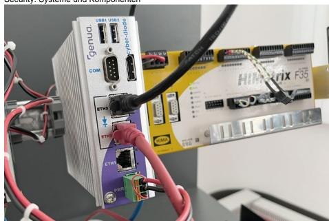
Die Datendiode sendet hier Daten per OPC UA sicher aus einer Sicherheitssteuerung an eine Cloudanwendung (Bild: genua).
