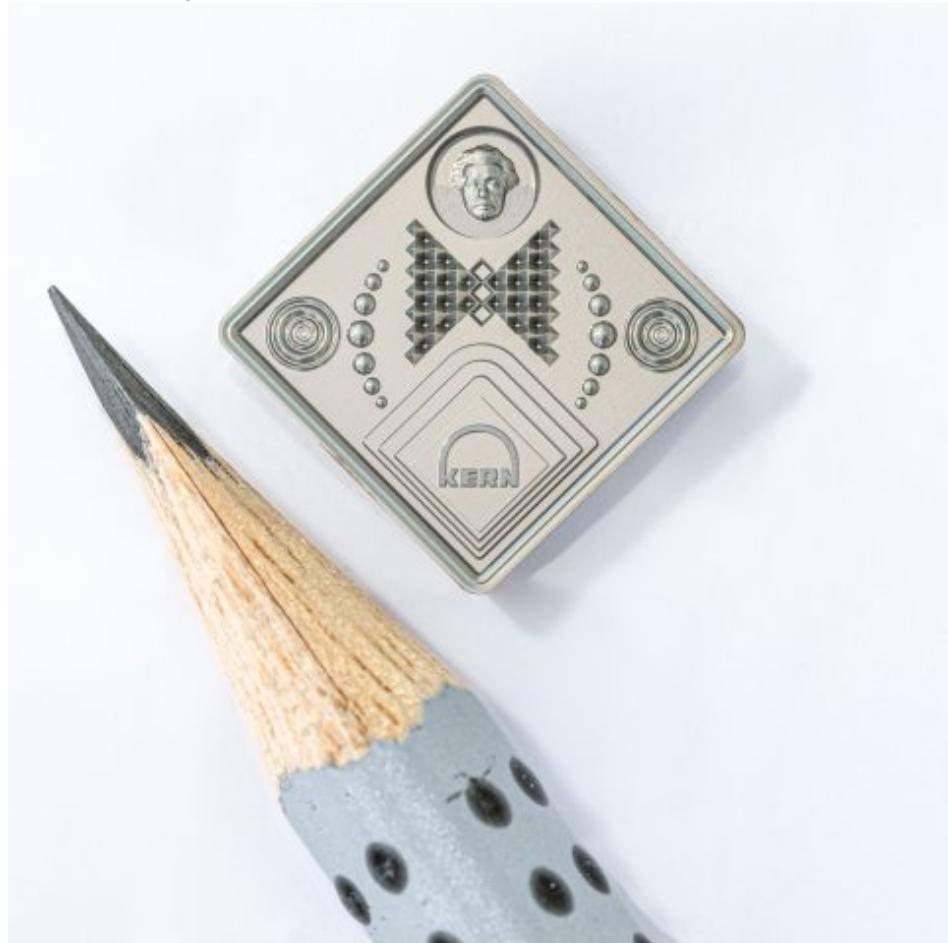
An diesem kleinen Musterbauteil wird die hohe Leistungsfähigkeit der Laser-Bearbeitungszentren sichtbar (Bild: Kern Microtechnik).
