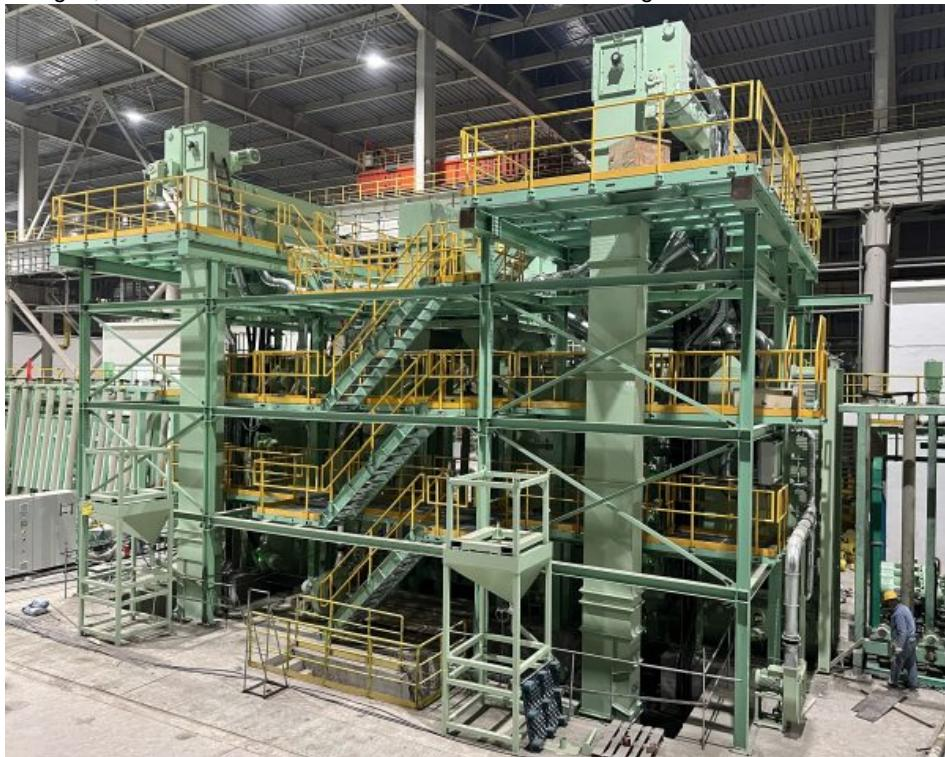
Die Vertikalstrahlanlage von Rösler ist 14 m hoch und steht in einer 2,5 m tiefen Grube (Bild: Tisco).
