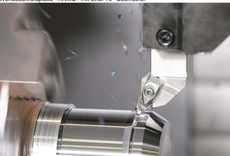
Die »Neoturn«-Drehwerkzeuge wurden für das Außen- und Innendrehen entwickelt (Bild: Iscar).
