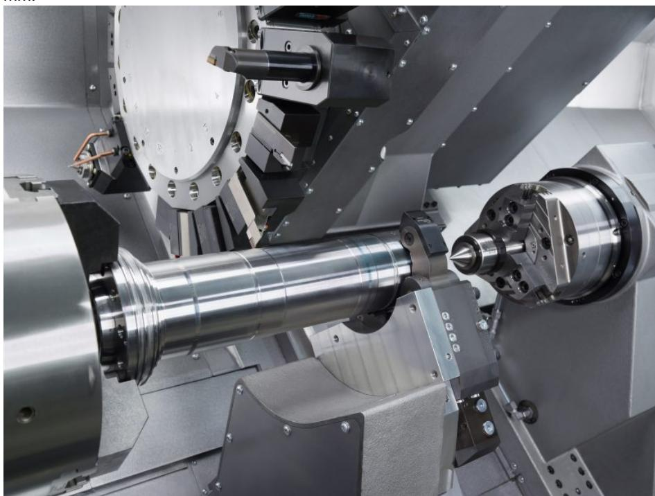
»B500« als Langversion bis 1200 mm Drehlänge und neuem Werkzeugrevolver mit 18 Werkzeugplätzen (Bild: Index).
