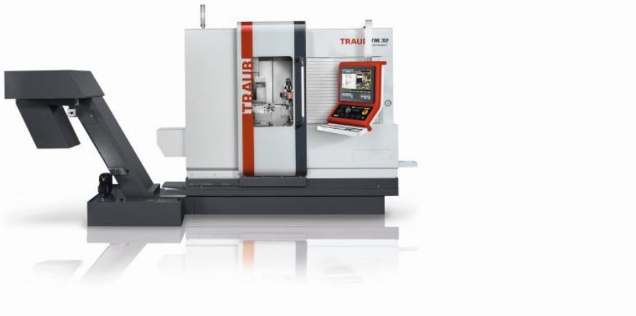
Der neue Lang-Kurzdrehautomat »TNL32« compact (Bild: Index).
