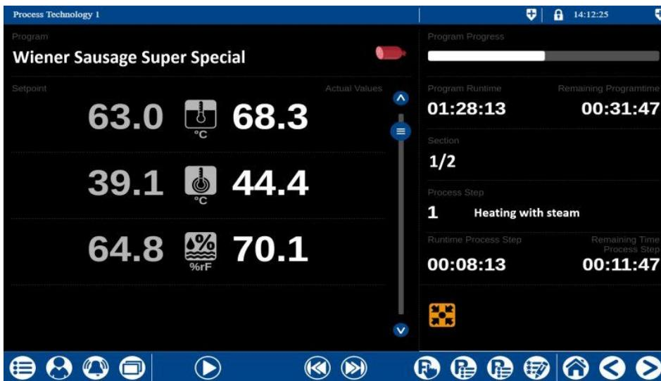
Der Prozess wird zum Beispiel auf einem Web-Panel oder auf dem HMI visualisiert (Bild: Jumo).
