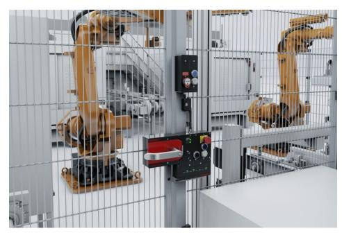
Das Türschließsystem kann über Profinet/Profisafe, Ethercat P/FSoE und Ethercat/FSoE kommunizieren (Bild: Euchner).
