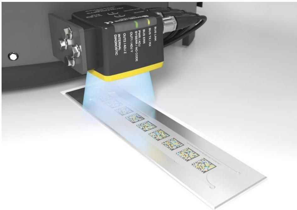
Das 2D-Positioniersystem, hier mit geschlossener Versenkschiene, liefert Positionsdaten an definierter Station (Bild: Pepperl+Fuchs).
