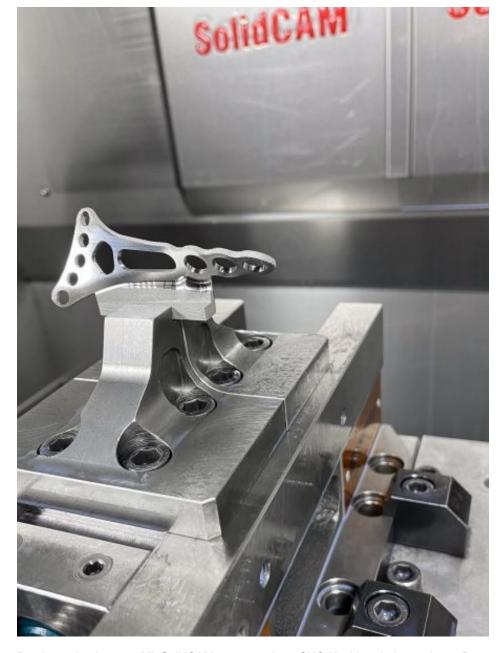
Durchgängige Lösung: Mit SolidCAM programmierte CNC-Nachbearbeitung eines 3D-gedruckten Knochenplattenrohlings (Bild: SolidCAM).
