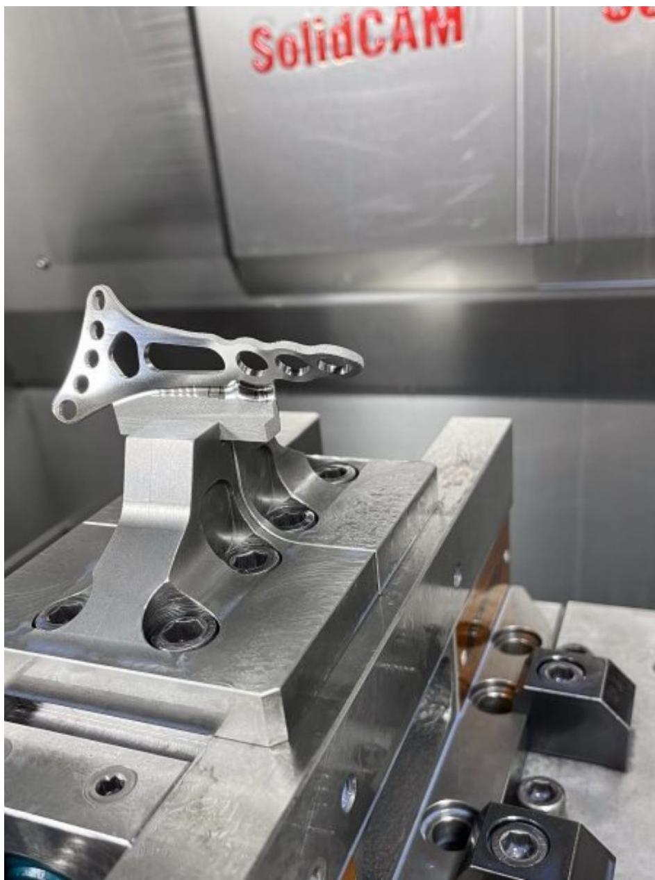
Durchgängige Lösung: Mit SolidCAM programmierte CNC-Nachbearbeitung eines 3D-gedruckten Knochenplattenrohlings (Bild: SolidCAM).
