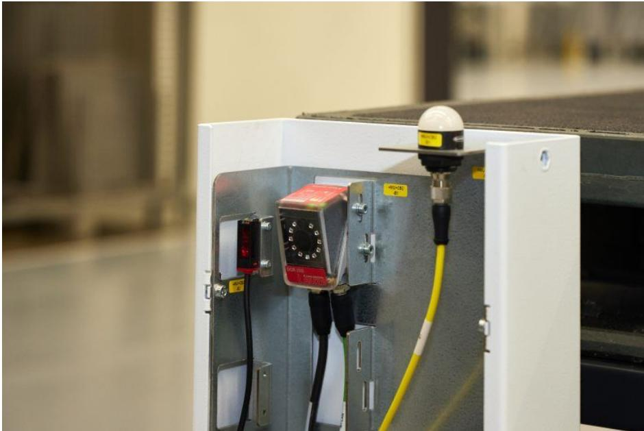
Die Sensortechnik an einer Dockingstation im Detail. Unter der geöffneten Abdeckung ist links ein »HT5.1/4X« zur Anwesenheitserkennung der Palette installiert. Der kamerabasierte Codeleser »DCR 202iC« (Mitte) erfasst Auftrags- und Materialdaten über den 2D-Code der Palette. Das Signallicht rechts informiert über den aktuellen Status per Farbsignal (Bild: Leuze).
