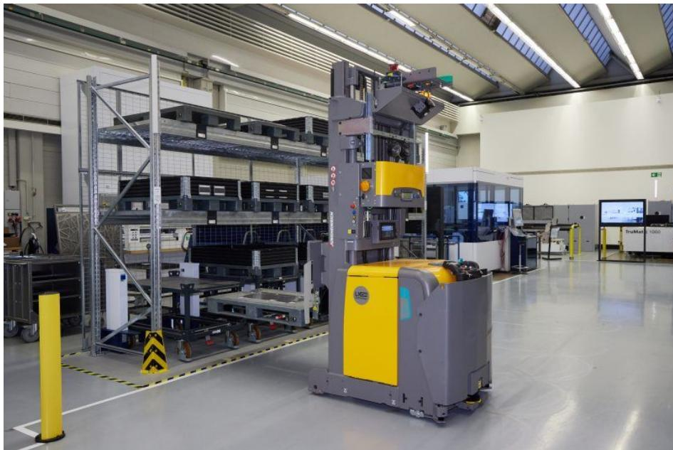
Ein fahrerloses Transportsystem bestückt eine Dockingstation mit Material. Die Sensorik in den grauen Stelen trägt dazu bei, den vollvernetzten Materialfluss zuverlässig, sicher und effizient zu realisieren (Bild: Leuze).
