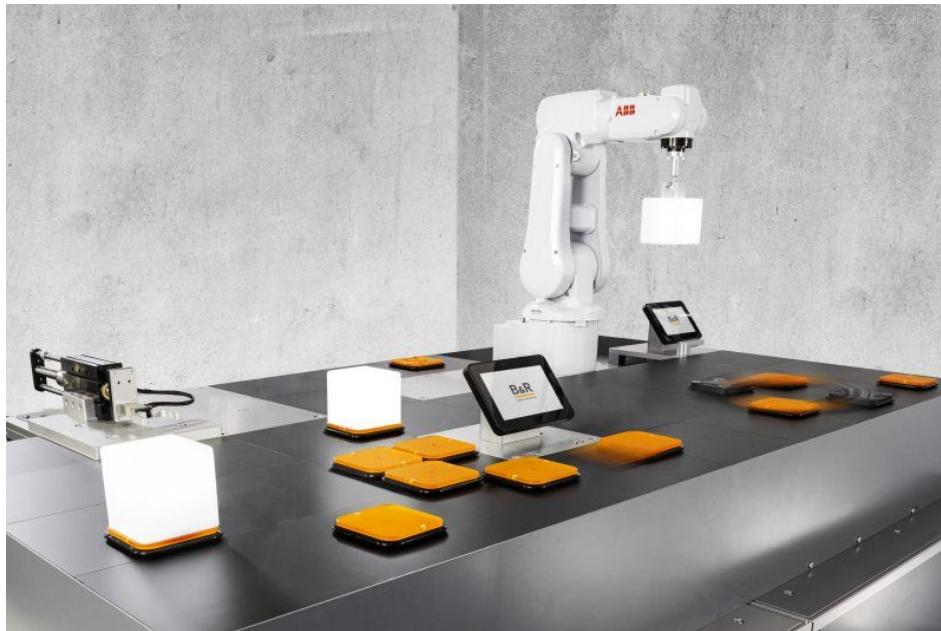
Bei »Acopos 6D« transportieren magnetisch schwebende Shuttles Produkte völlig individuell durch die Maschine (Bild: B&R).
