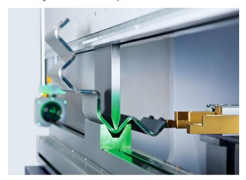
Kontakt: Die Abkantpresse erstellt eine Biegekontur mit dem vorgegebenen Biegewinkel. Links im Bild die Empfängereinheit des Schutz- und Messsystems (Bild: Bystronic/Pilz).
