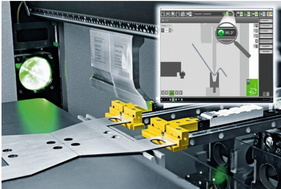
Ist der Winkel korrekt? Unmittelbar nach dem Biegevorgang stellt das Biegewinkelmodul des kamerabasierten Messsystems den realisierten Biegewinkel auf dem Bediendisplay dar (Bild: Bystronic/Pilz).
