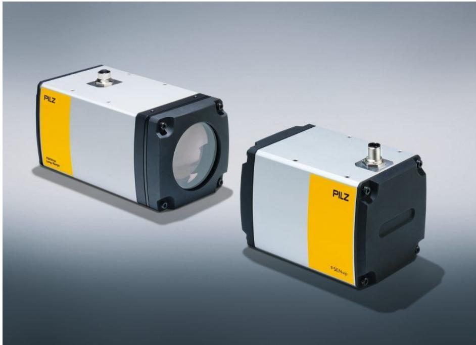
Mit dem Modul zur Biegeinkelmessung werden verwertbare Bilddaten vom kamerabasierten Schutzsystem »PSENvip 2« direkt an die Pressensteuerung weitergeleitet und dadurch ein effizienter Abkantprozess gewährleistet. Sowohl die aufwendige Messung der Winkel per Hand als auch teure Wegmesssysteme entfallen (Bild: Pilz).
