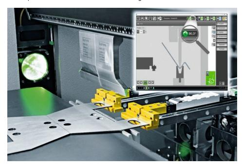
Ist der Winkel korrekt? Unmittelbar nach dem Biegevorgang stellt das Biegewinkelmodul des kamerabasierten Messsystems den realisierten Biegewinkel auf dem Bediendisplay dar (Bild: Bystronic/Pilz).
