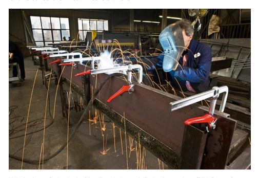
Hebelzwingen finden in der Metallbearbeitung vielfache Anwendung (Bild: Bessey).
