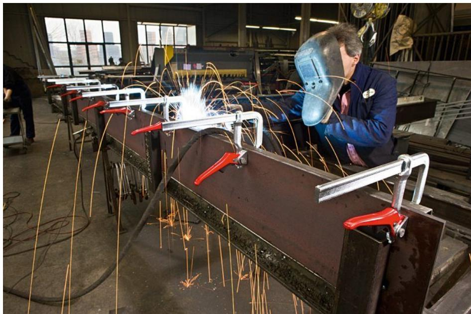
Hebelzwingen finden in der Metallbearbeitung vielfache Anwendung (Bild: Bessey).
