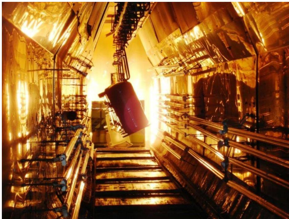
Infrarot-Booster unterstützen dabei, einen Trocknungsprozess stark zu beschleunigen, ohne den bestehenden Ofen entsorgen zu müssen (Bild: Heraeus Noblelight).
