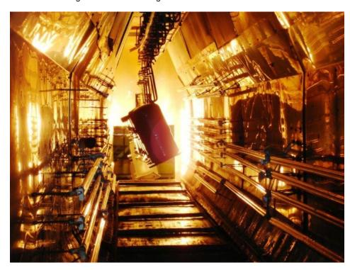
Infrarot-Booster unterstützen dabei, einen Trocknungsprozess stark zu beschleunigen, ohne den bestehenden Ofen entsorgen zu müssen (Bild: Heraeus Noblelight).
