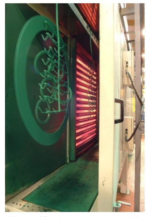
Bei Klinger muss der IR-Ofen nur dann angeschaltet werden, wenn er benötigt wird. Das führte zu spürbaren Energieeinsparungen (Bild: Heraeus Noblelight).
