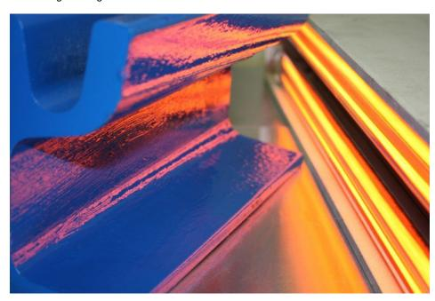
Viele Wärmeprozesse in der Metallverarbeitung werden durch Infrarot-Wärmetechnologie gelöst. Richtig eingesetzt, kann hier die nötige Energie besonders effizient verwendet werden (Bild: Heraeus Noblelight).
