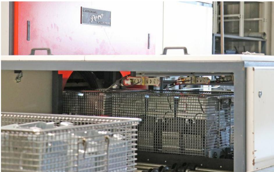
Die große Vollvakuum-Reinigungsanlage kann gleichzeitig zwei Körbe aufnehmen und ist dadurch besonders produktiv (Bild: Pero).
