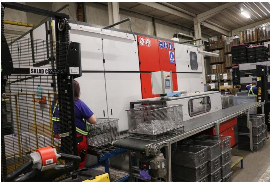
Während die zu reinigenden Bauteile in durchlässigen Gitterkörben auf das Zuführsystem gesetzt werden, nimmt man oben die gereinigten Bauteile wieder vom Band. Dazwischen findet in der Anlage automatisch die Reinigung mit Lösemittel in Vollvakuum statt (Bilder: Pero).
