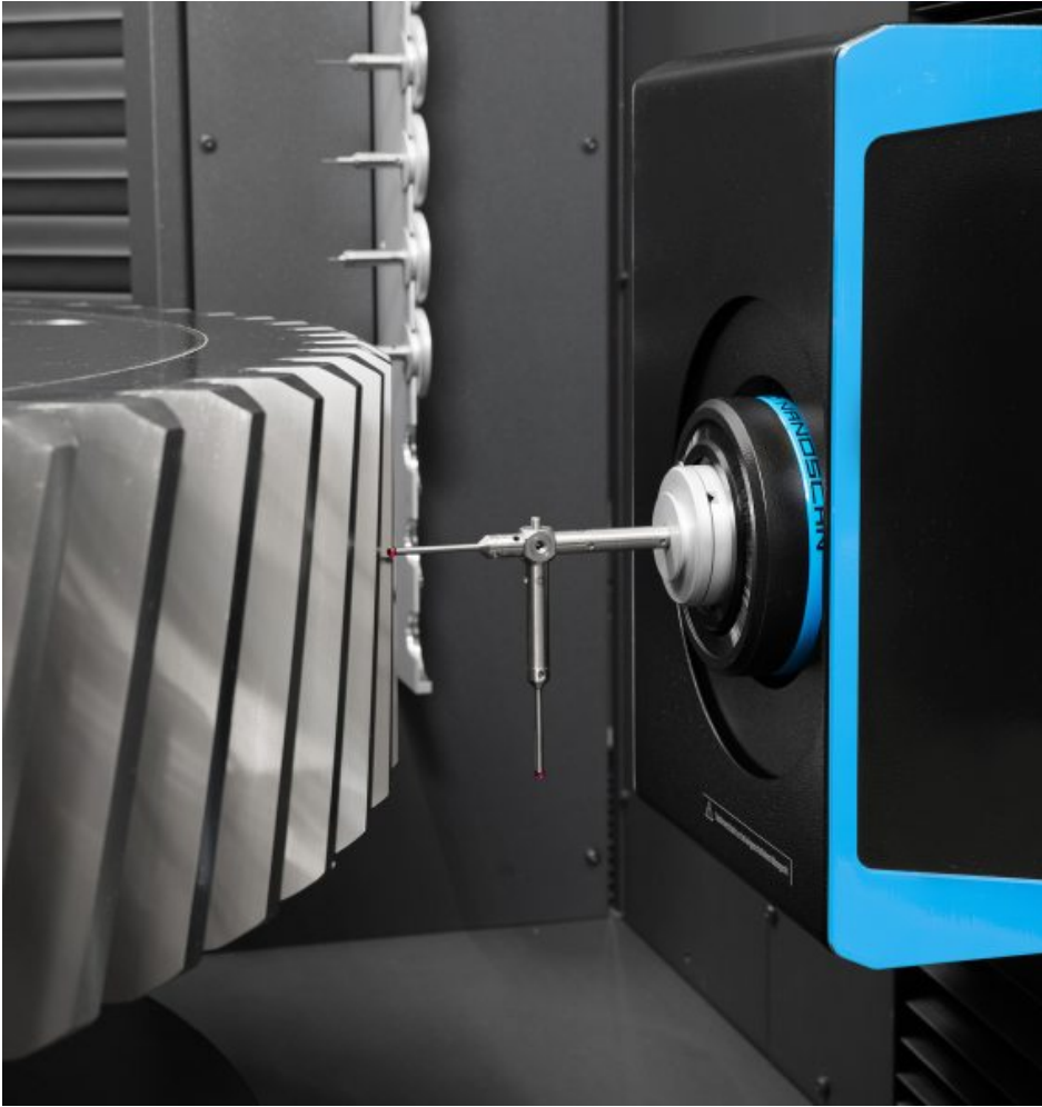
Präzisionsmesszentrum für mittelgroße Verzahnungen (Bild: Klingelberg).
