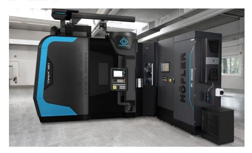
Produktionszelle bestehend aus Stirnrad-Wälzschleifmaschine, Beladeeinheit und integrierter Stirnrad-Wälzprüfmaschine (Bild: Klingelnberg).
