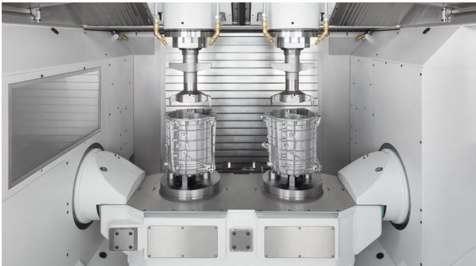
Ein Messe-Highlight ist das Fräs-Drehzentrum »DZ 22 S mill turn« im Livebetrieb bei der Bearbeitung von E-Motorengehäusen (Bild: Chiron).
