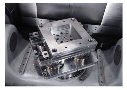
Das Mehrfach-Spannsystem mit Spannbolzen direkt auf einem Nullpunkt-Spannsystem montiert. Das Spannen des Werkstücks erfolgt mit Festbacke (rechts) und Keilspanner mit Festbacke (links; Bild: Kipp).
