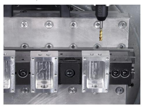
Das Mehrfach-Spannsystem lässt sich mit Keilspannern doppelseitig und verschiedenen Festbacken kombinieren (Bild: Kipp).
