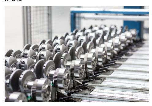
Einblick in die Kurbelwellenfertigung bei Deutz (Bild: Deutz).
