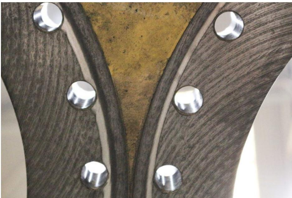
Logaer Maschinenbau muss zwölf Lochkreise mit jeweils 26 Stufenbohrungen mit einer Tiefe von 100 Millimetern in die Komponenten aus Grauguss einbringen (Bild: Iscar).
