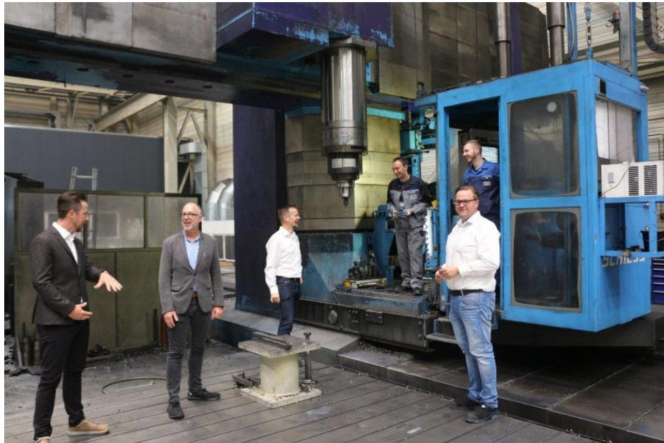
Die Portalfräsmaschine mit 13,5 Metern Verfahrweg lieferte ausreichend Leistung, um die notwendigen hohen Schnittwerte fahren zu können (Bild: Iscar).
