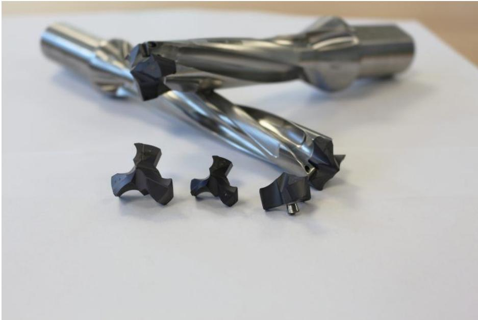
Zum Einsatz kamen zwei Wechselkopfbohrer mit 25 und 21 Millimetern Durchmesser. Dank hoher Schnittwerte konnte das Unternehmen die Bearbeitungszeit pro Bauteil halbieren (Bild: Iscar).
