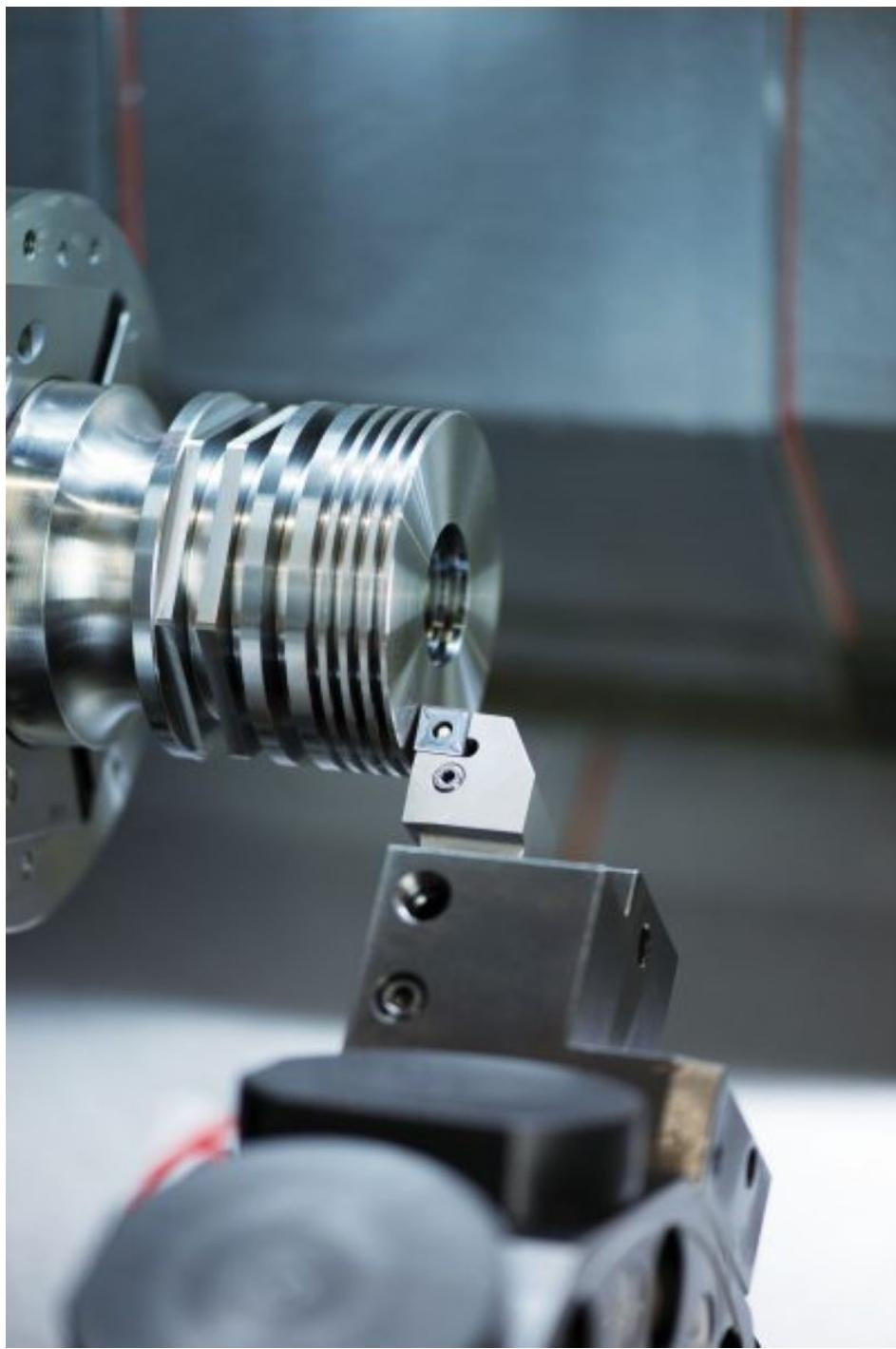
Dank der besonders temperaturbeständigen Sorte zum Drehen von Stahl und nichtrostendem Stahl sind sehr lange Standzeiten möglich (Bild: ZCC Cutting Tools Europe).
