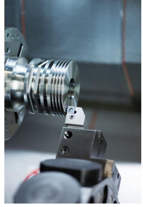
Dank der besonders temperaturbeständigen Sorte zum Drehen von Stahl und nichtrostendem Stahl sind sehr lange Standzeiten möglich (Bild: ZCC Cutting Tools Europe).
