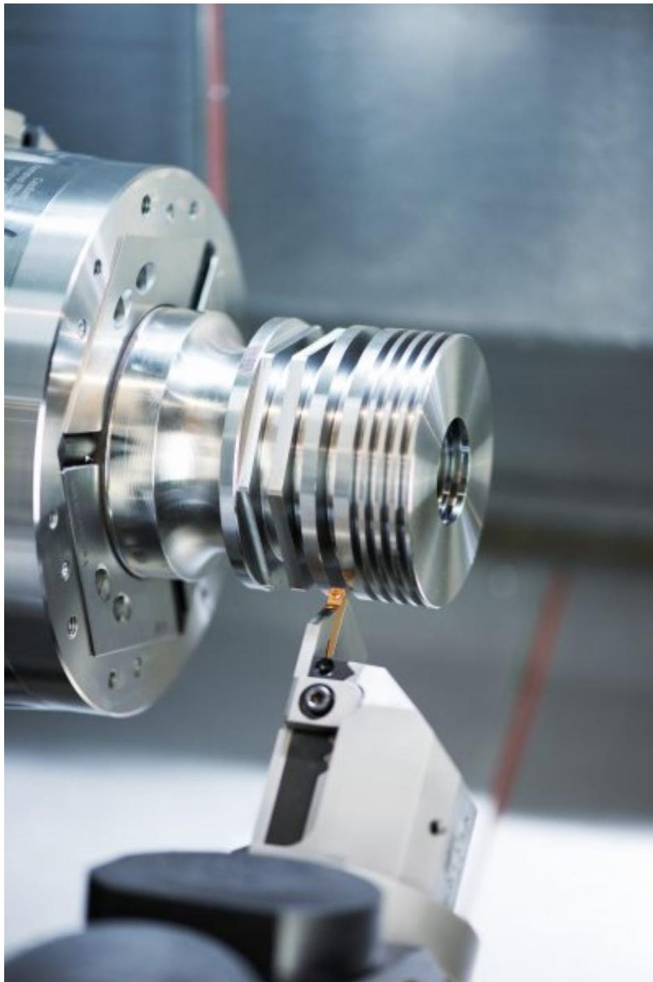
Die 3D-optimierten Spanformelemente sorgen für eine höchstmögliche Spankontrolle
