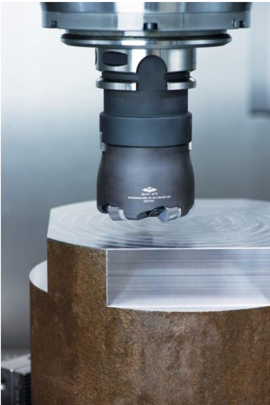
High Performance für Superlegierungen: Die Sorte »CSX1000« ist auch mit dem neuen Rundplattenfrässystem »FMR06« einsetzbar (Bild: ZCC Cutting Tools Europe).
