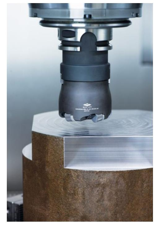
High Performance für Superlegierungen: Die Sorte »CSX1000« ist auch mit dem neuen Rundplattenfrässystem »FMR06« einsetzbar (Bild: ZCC Cutting Tools Europe).
