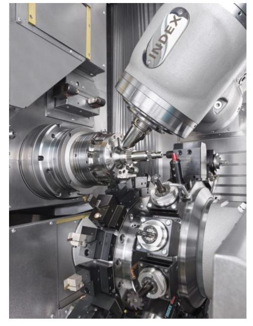
Dank der kräftigen Motorfrässpindel vergrößert sich das Bearbeitungsspektrum (Bild: Index).
