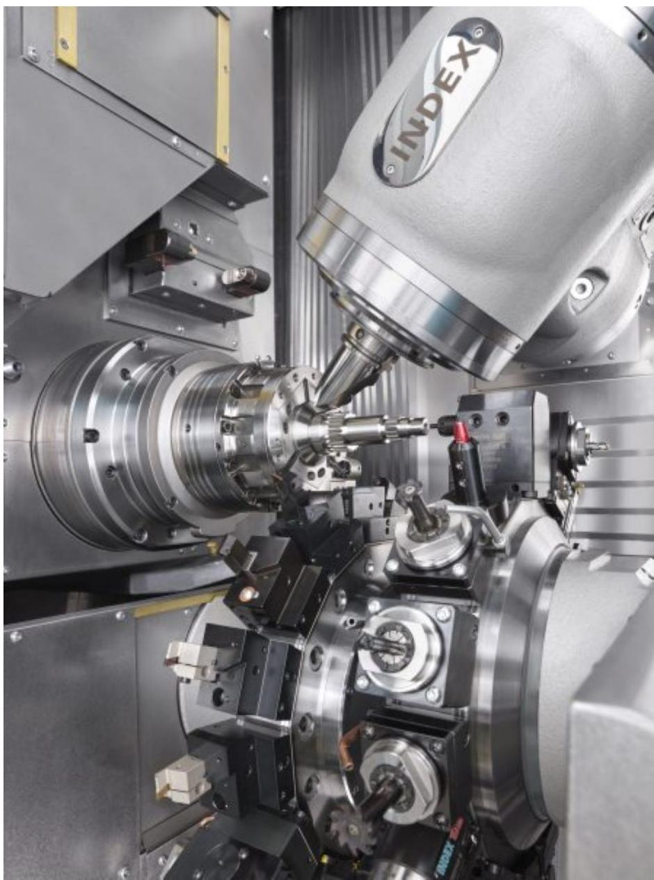
Dank der kräftigen Motorfrässpindel vergrößert sich das Bearbeitungsspektrum (Bild: Index).
