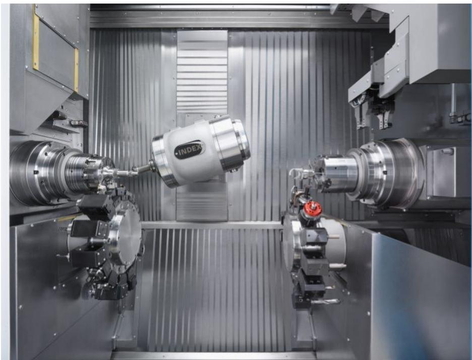
Beide Dreh-Fräszentren sind mit zwei Werkzeugrevolvern sowie einer leistungsstarken Motorfrässpindel ausgestattet und sind so für die Komplettbearbeitung gerüstet (Bild: Index).
