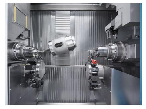
Beide Dreh-Fräszentren sind mit zwei Werkzeugrevolvern sowie einer leistungsstarken Motorfrässpindel ausgestattet und sind so für die Komplettbearbeitung gerüstet (Bild: Index).
