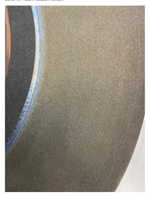
Oben: eine beschichtete, ungeschliffene Bremsscheibe (Bild: Supfina).
