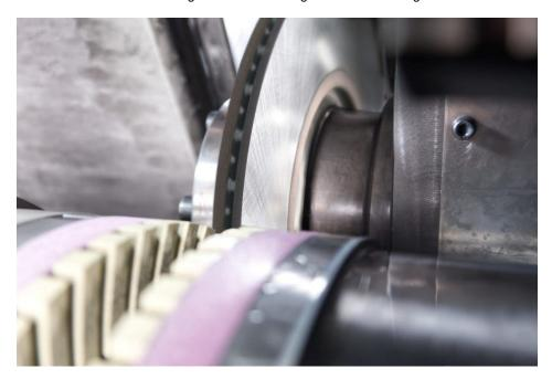
Doppelplanschleifen einer beschichteten Bremsscheibe (Bild: Supfina).
