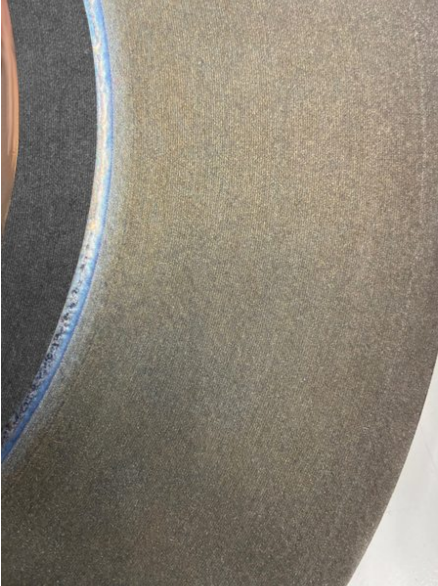
Oben: eine beschichtete, ungeschliffene Bremsscheibe (Bild: Supfina).
