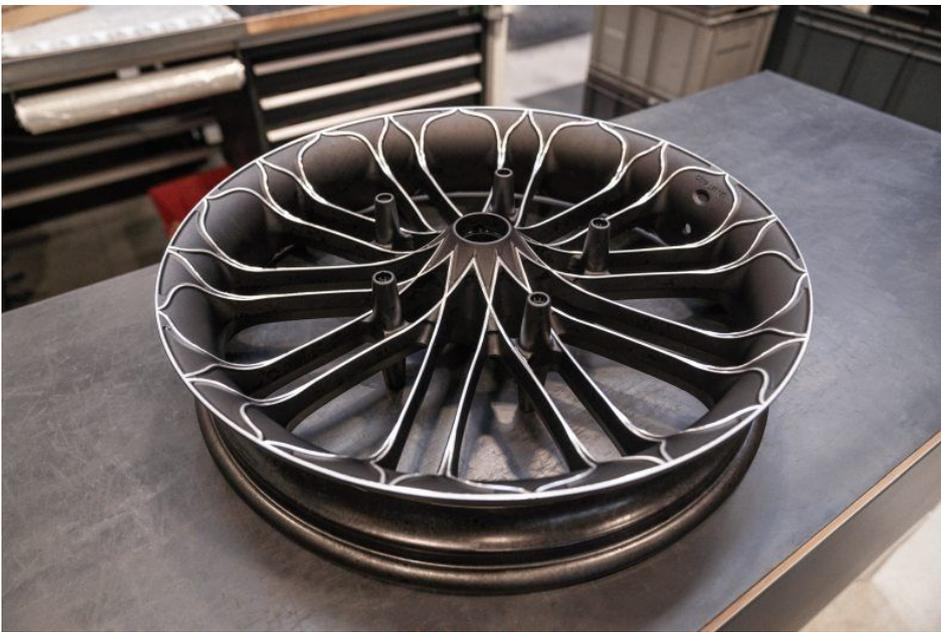
Nach dem Eloxieren der Monoblockfelge werden zum Beispiel noch einzelne Details wieder freigeätzt, die das Design betonen (Bild: Hermle).
