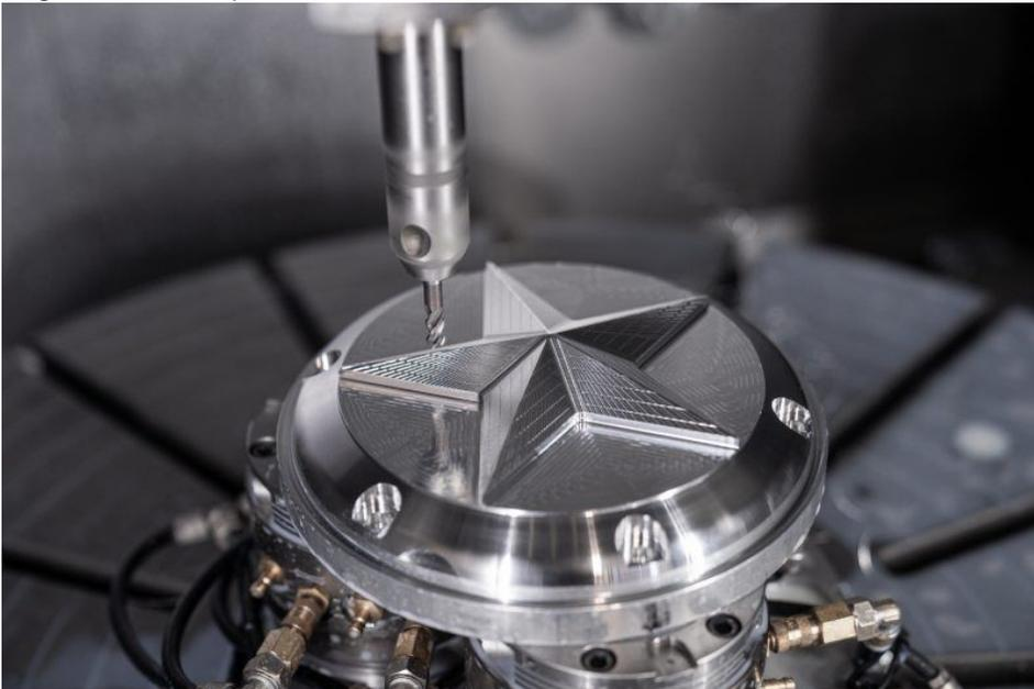
Das Bearbeitungszentrum »C 42 U MT« fräst in nur wenigen Minuten den Deckel mit Stern aus dem Rohling (Bild: Hermle).
