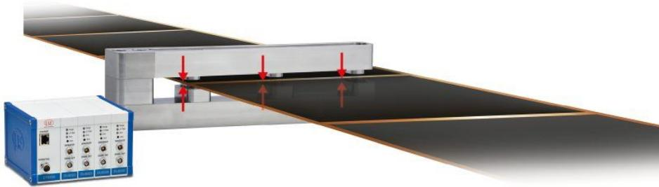
Anwendungsbeispiel Batterieproduktion: Um die Dicke des Anoden- und Kathodenmaterials der Nassschicht zu messen, ist eine Genauigkeit von  $<\pm 1 \mu\text{m}$  bei 150 bis 500  $\mu\text{m}$  Objektdicke gefordert. Für diese Messaufgabe wird ein System mit C-Rahmen und zwei konfokalen Sensoren eingesetzt (Bild: Micro-Epsilon).
