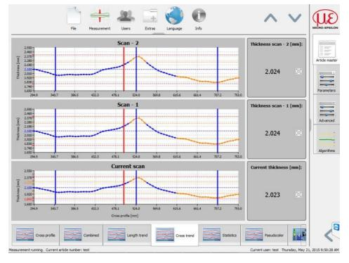
Die »thicknessGauge«-Systeme verfügen über ein multitouchfähiges Softwarepaket zur Analyse, Darstellung und Archivierung der überwachten Produktionsdaten. Die Software ermöglicht zudem unterschiedliche Messmodi (Bild: Micro-Epsilon).
