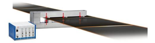
Anwendungsbeispiel Batterieproduktion: Um die Dicke des Anoden- und Kathodenmaterials der Nassschicht zu messen, ist eine Genauigkeit von <±1  $\mu$ m bei 150 bis 500  $\mu$ m Objektdicke gefordert. Für diese Messaufgabe wird ein System mit C-Rahmen und zwei konfokalen Sensoren eingesetzt (Bild: Micro-Epsilon).
