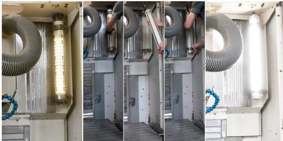
Einfacher Tausch: Die »TubeLED\_70« passt mit ihrem Leuchtenkörper exakt in bestehende Halterungen (Bild: LED2Work).
