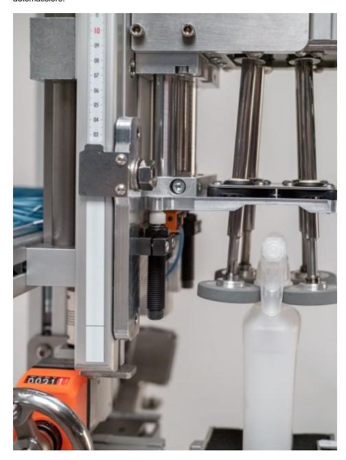
Pumpsprühflasche im Griff von Reibrädern, links daneben Kleinstoßdämpfer von ACE, die der Erhöhung von Taktraten sowie in der unteren Endlage als Begrenzung der Schließbewegung dienen und zudem bei einer Havarie die Gesamtkonstruktion schützen (Bild: Metallatelier).
