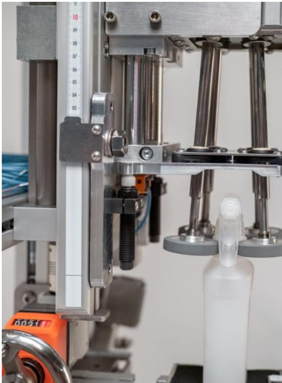
Pumpsprühflasche im Griff von Reibrädern, links daneben Kleinststoßdämpfer von ACE, die der Erhöhung von Taktraten sowie in der unteren Endlage als Begrenzung der Schließbewegung dienen und zudem bei einer Havarie die Gesamtkonstruktion schützen (Bild: Metallatelier).
