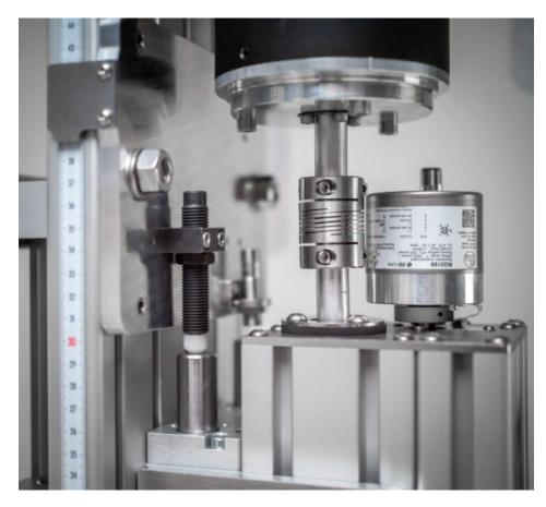
Getriebegehäuse mit Drehmomentbegrenzer, Drehwinkelsensor und Stoßdämpfer für oberen Anschlag, an dem ein Kleinstoßdämpfer Typ »MC150EUMH« eingesetzt wird, um daneben einem Endlagensensor den nötigen Platz einzuräumen (Bild: Metallatelier).
