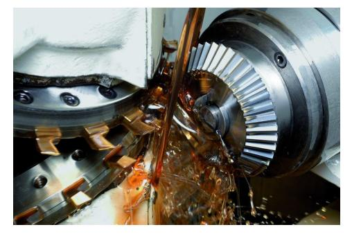
Die umfangreichen Fertigungsmöglichkeiten von Mädler umfassen auch das Kegelradfräsen (Bild: Mädler).
