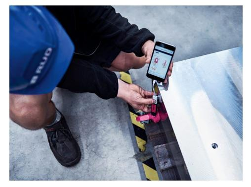
Bei allen Varianten sind serienmäßig RFID-Transponder integriert. Damit werden Prüfzeiten und -kosten verringert sowie die Prozesssicherheit erhöht (Bild: RUD).
