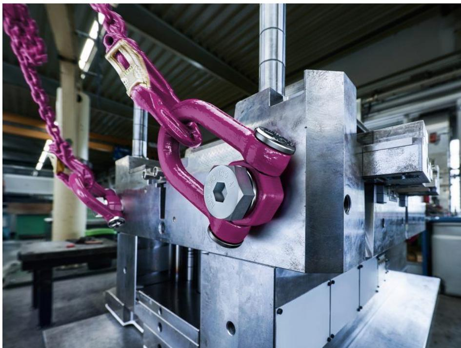
»ACP-Turnado« eliminiert in allen Größenvarianten ein Stehenbleiben in der gefährlichen 90-Grad-Stellung und dreht sich ohne gefährliche Querbelastungen automatisch in Lastrichtung ein (Bild: RUD).
