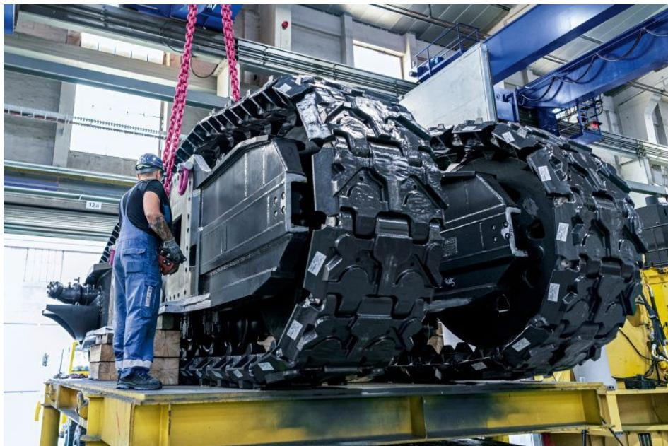
In Größen von M8 bis M100 sowie  $\frac{1}{2}$ " bis 4" sind die Anschlagpunkte für eine noch größere Vielfalt an Einsätzen geeignet (Bild: RUD).
