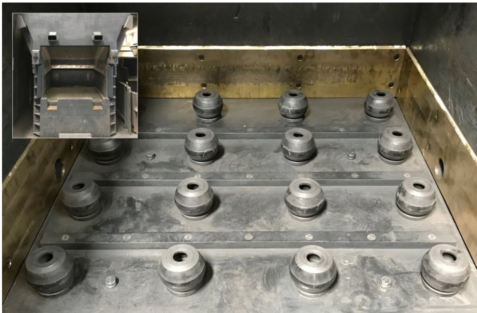
Schutzvorrichtung, bestehend aus 20 Strukturdämpfern der ACE Stoßdämpfer GmbH, auf denen die Schublade der Krätzesortieranlage im Betrieb gelagert ist. Bild: ACE
