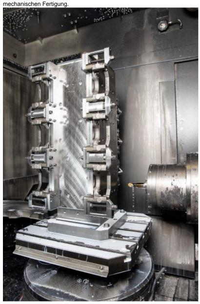
Zur Bearbeitung werden die 14 Rohlinge auf einen Turm gespannt (Bild: Horn/Sauermann).
