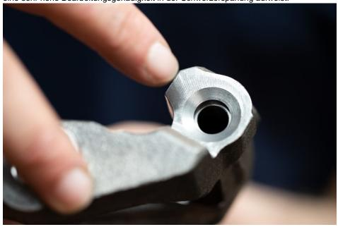
Neben den gesparten Werkzeugwechseln der Maschine verbesserte sich die Bearbeitungszeit der Profilbohrung um 30 Sekunden (Bild: Horn/Sauermann).
