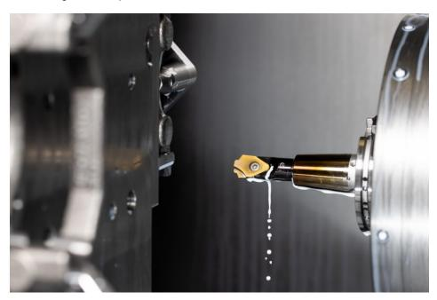
Mit dem neuen Formbohrwerkzeug wird das Bohrungsprofil jetzt in einem Arbeitsgang statt in drei Arbeitsgängen erstellt (Bild: Horn/Sauermann).
