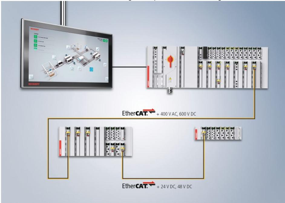
Mit dem »MX-System« und Ethercat wird aus dem konventionellen zentralen Ansatz ein dezentral verteilter Schaltschrank (Bild: Beckhoff).
