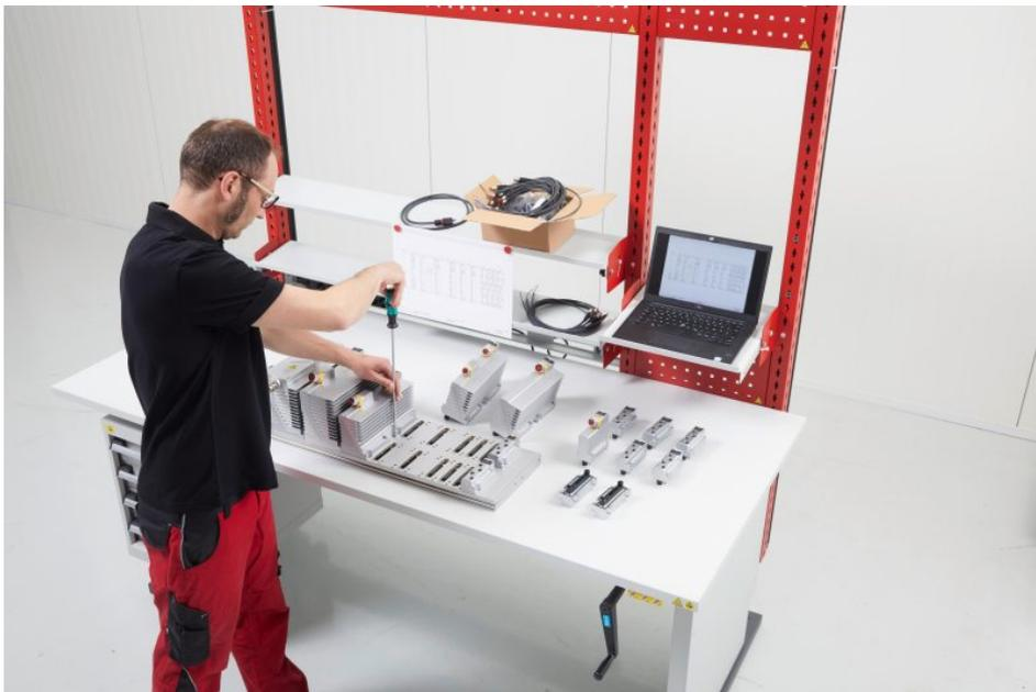
Für die Montage wird nur ein Arbeitsplatz benötigt, an dem das gesamte System mit nur einem Werkzeug aufgebaut werden kann (Bild: Beckhoff).
