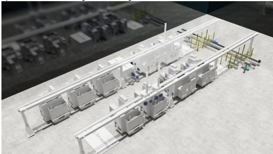
Darstellung der Produktionslinie für Elektroantriebe mit agilen Fertigungszellen (Bild: MAG-IAS).
