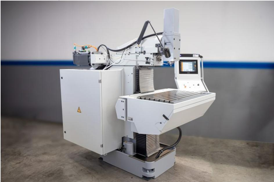
Die überarbeitete manuelle Fräs-Bohrmaschine mit fest verbautem Schaltschrank ist besonders kompakt (Bild: FPS).
