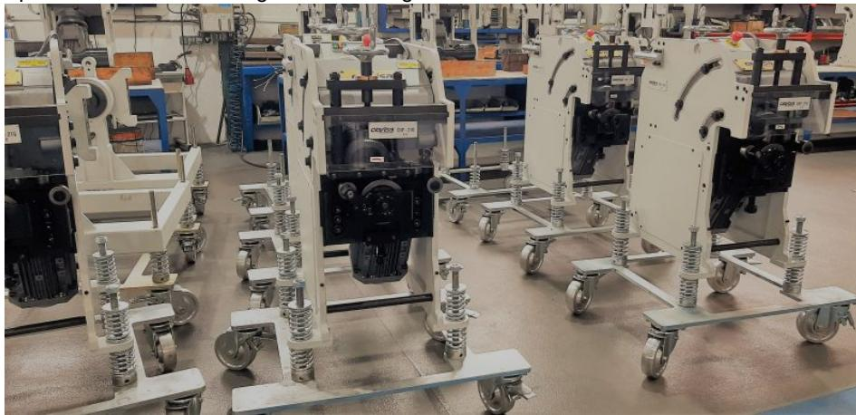
Geräte zur mechanischen Schweißnahtvorbereitung arbeiten energieeffizient und schonend (Bild: Cevisa).
