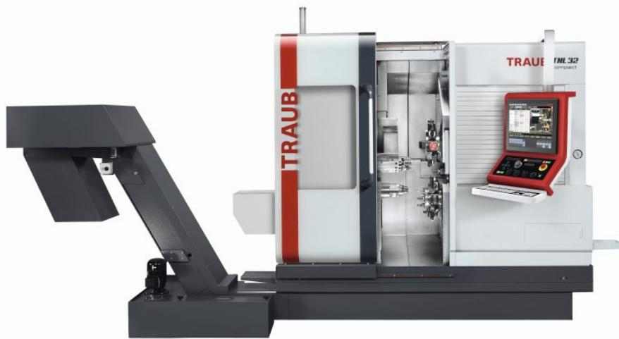
Der kompakte Lang-Kurzdrehautomat kommt mit einer verkleinerten Aufstellfläche aus (Bild: Index).
